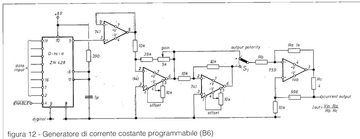
figura 12 - Generatore di corrente costante programmabile (B6)
